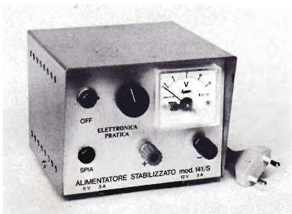
Di facilissima costruzione e di grande utilità nel laboratorio dilettaistico, l'alimentatore stabilizzato è dotato di una moderna protezione elettronica, che permette di tollerare ogni eventuale errore d'impiego del dispositivo, perché la massima corrente d'uscita viene limitata automaticamente in modo da proteggere l'alimentatore da eventuali cortocircuiti.
