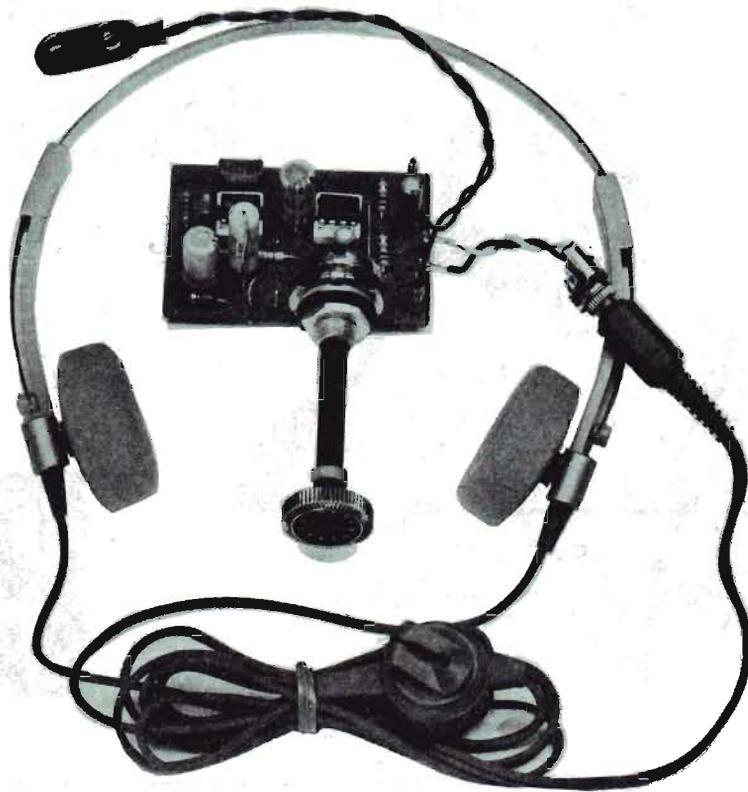
**Fig. 8 - Per il completamento del dispositivo, che consente l'ascolto dei suoni deboli o lontani, mancano, in questa riproduzione fotografica, l'interruttore S1 e la pila di alimentazione. Ma se si usa una pila da 9 V, si può fare a meno dell'interruttore, dato che lo spegnimento del circuito si ottiene disinserendo la pila stessa dalla presa polarizzata.**
